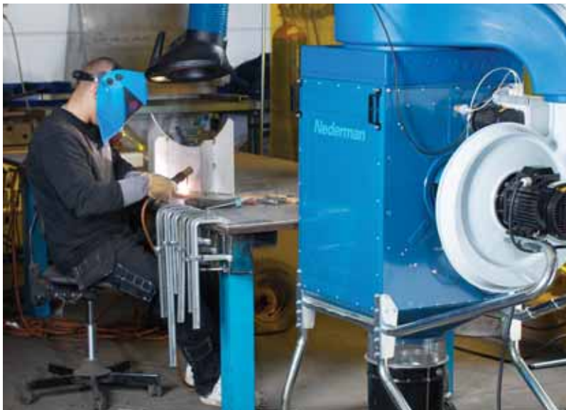
Система FilterBox в сборе с вытяжным рукавом Original.
