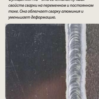
Функция MIX TIG – это сочетание лучших свойств сварки на переменном и постоянном токе. Она облегчает сварку алюминия и уменьшает деформацию.
